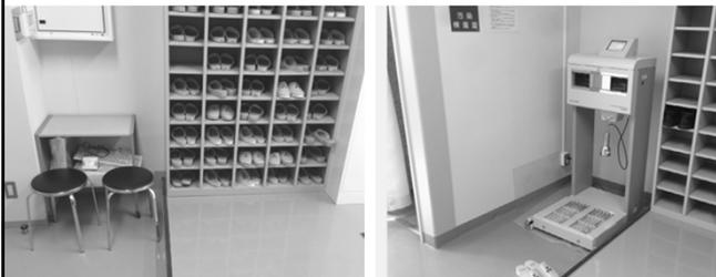
奥の実験室へ入る際は、黄色スリッパに履き替える。(履物底にRI汚染があっても、ここで床の汚染が止められる。) ハンドフットクロスモニタで手やスリッパ底などの汚染検査を行う。
