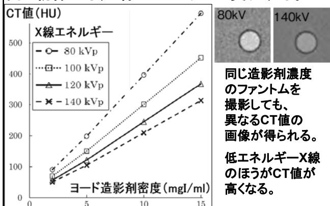
X線エネルギーが低いほど、同じ物体でも、X線の減弱は増加するので、線減弱係数  $\mu$ 、および  $\mu$  から算出するCT値は、大きくなる。この現象を利用したCTが デュアルエネルギーCT (DECT: Dual Energy CT) である。
