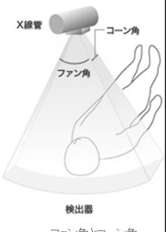
中心部から外れた(コーン角が大きい)部位ほど像の歪みなどのアーチファクトがあり、幾何学的歪み補正を実施して断層像を再構成する必要がある。
