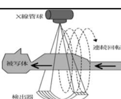
X線管球が高速連続回転し、患者ベッドが一定速度で移動するので、らせん状にX線が通過。検出器も体軸方向に複数(現在は最大320列)並び(マルチスライスCT MultiSlice CT, MSCT)短時間で広範囲多断面を撮影できる。体軸方向データに切れ目がないので体軸方向の断面像も良好に得られる。
