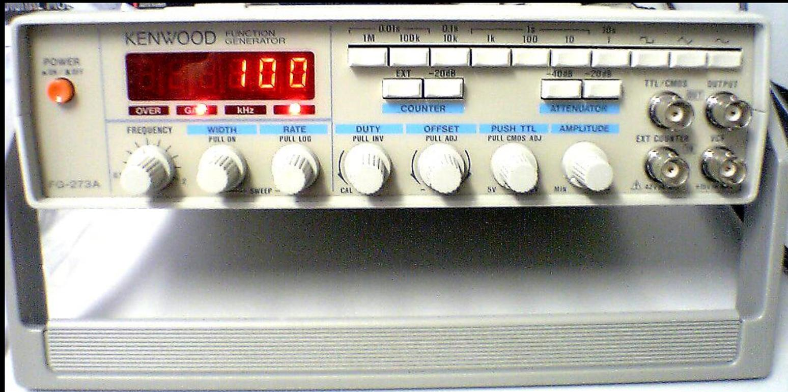
発信器で 50Hzの交流電圧を発生させる
