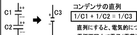
直列にすると、電気的につながった電極面同士で電子(電荷)を中和してしまうので、蓄える電荷量が減る。
