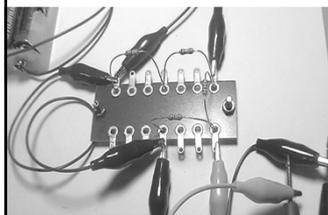
各抵抗に発生する電圧を測定して、キルヒホッフの法則から算出される値と比較する。
