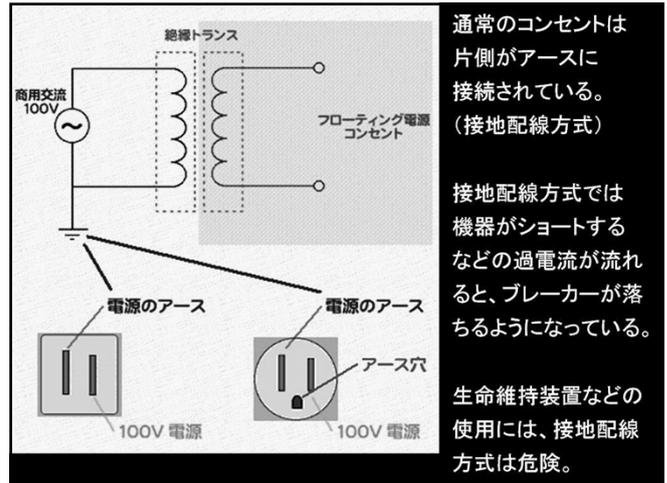
通常のコンセントは片側がアースに接続されている。(接地配線方式)
