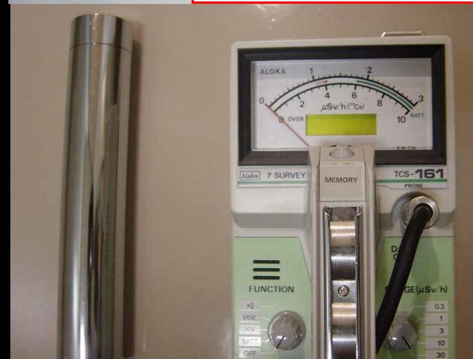
$^{131}\text{I}$  内服患者の呼気、尿、便から $^{131}\text{I}$ が排泄されるが、退出基準値を、1mでの線量当量率が30  $\mu\text{Sv}/\text{h}$  以下に定めることで、一般公衆の積算線量が、公衆の年線量限度 1mSv を下回ることが試算されている。
