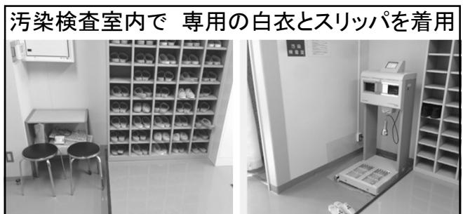
奥の実験室へ入る際は、黄色スリッパに履き替える。(履物底にRI汚染があつても、ここで床の汚染が止められる。) ハンドフットクロスモニタで手やスリッパ底などの汚染検査を行う。
