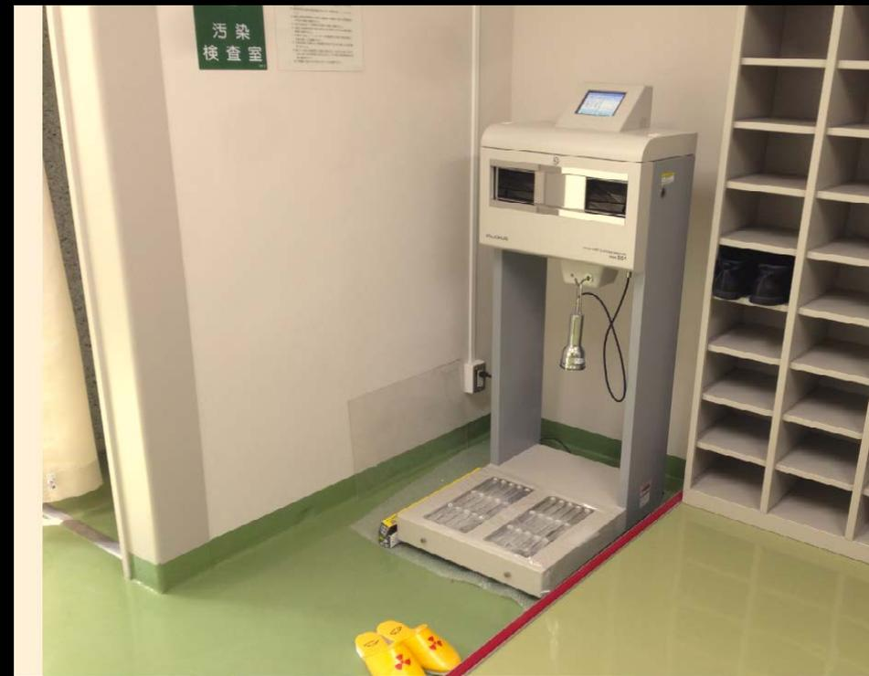
奥の実験室へ入る際は、黄色スリッパに履き替える。(履物底にRI汚染があっても、ここで床の汚染が止められる。) ハンドフットクロスモニターで手やスリッパ底などの汚染検査を行う。
