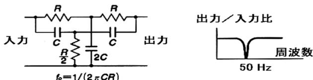
回路図のブロック f は、50Hzの周波数成分を除去する帯域除去フィルタ (BEF)。
